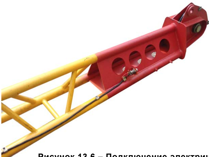
Рисунок 13.6 – Подключение электрического кабеля на гуське
