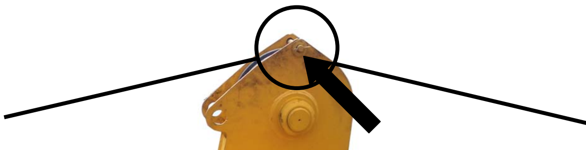
Рисунок 13.13 – Установка оси на блоке основания гуська
