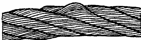
Рисунок Н.3 - Выдавливание сердечника
