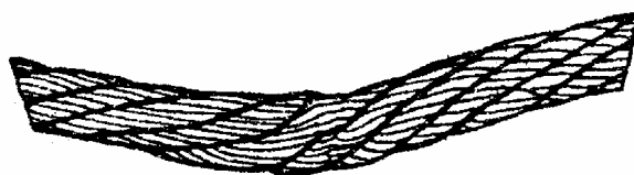
Рисунок Н.9 - Залом каната
