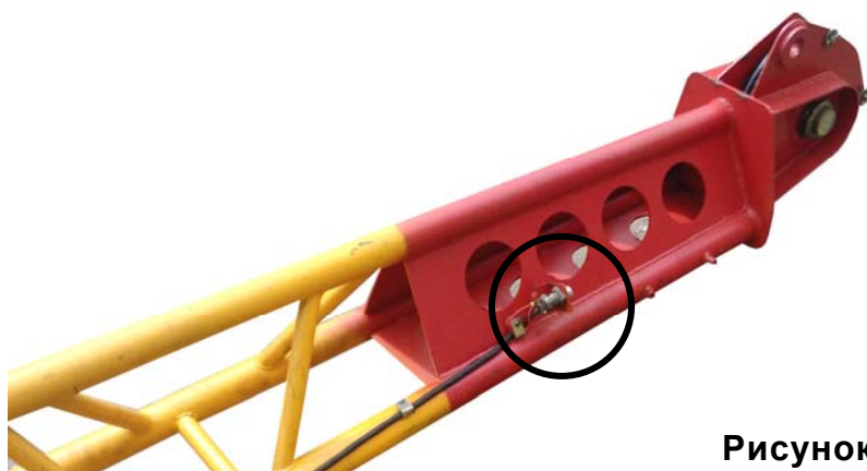
Рисунок 13.16 – Установка осей с фиксаторами на оголовке гуська
