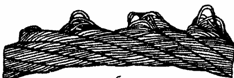
Рисунок Н.4 - Выдавливание проволок прядей
