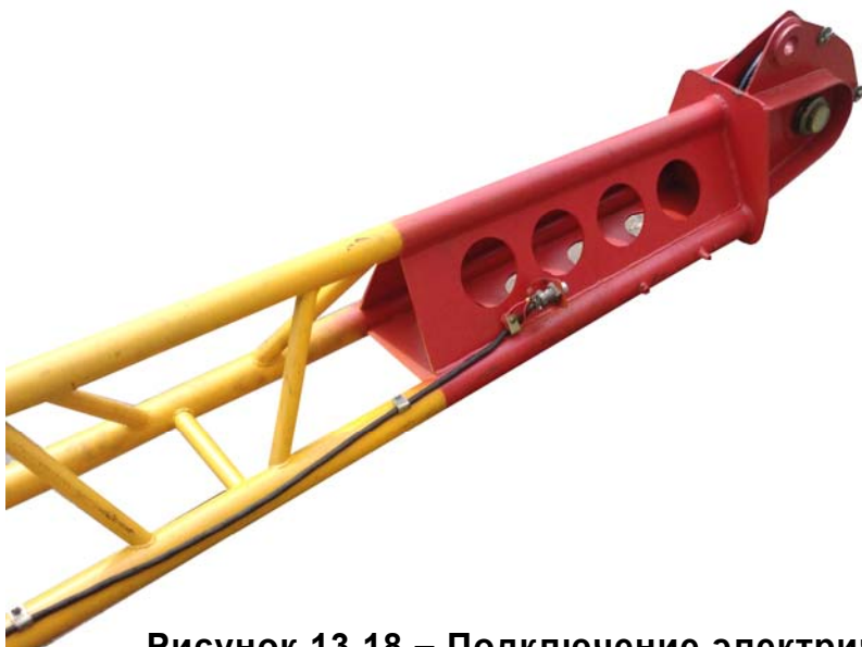
Рисунок 13.18 – Подключение электрического кабеля на гуське
