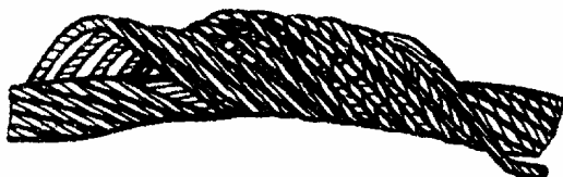
Рисунок Н.2 - Корзинообразная деформация
