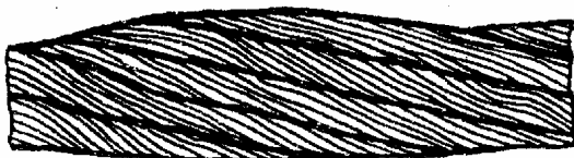
Рисунок Н.5 – Местное увеличение диаметра каната
